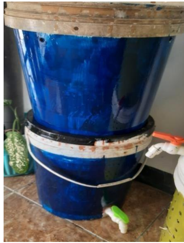
Gambar 1 Sistem Ember Tumpuk Yang Telah Siap Digunakan
