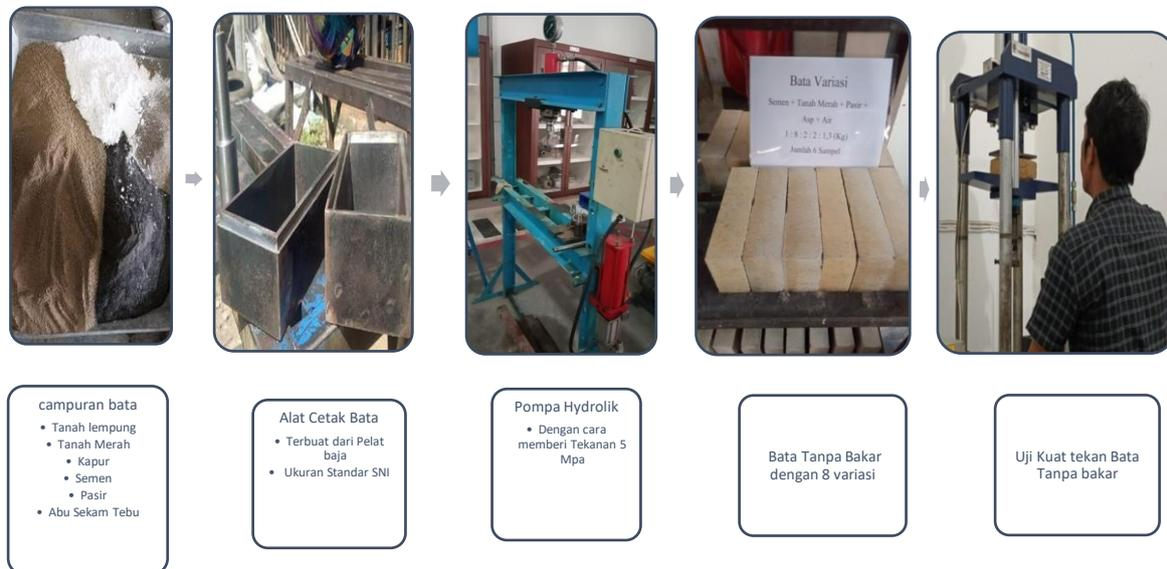
**Gambar 7.** Prosedur Kerja dari Pembuatan Bata tanpa Bakar sampai Uji Kuat Tekan Bata
