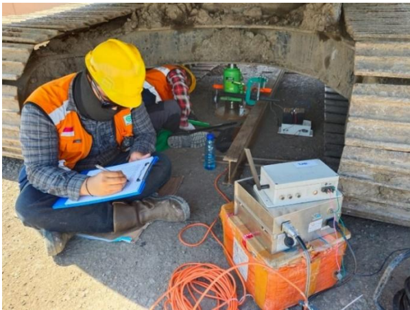
Gambar 2. Konfigurasi peralatan static plate load test
